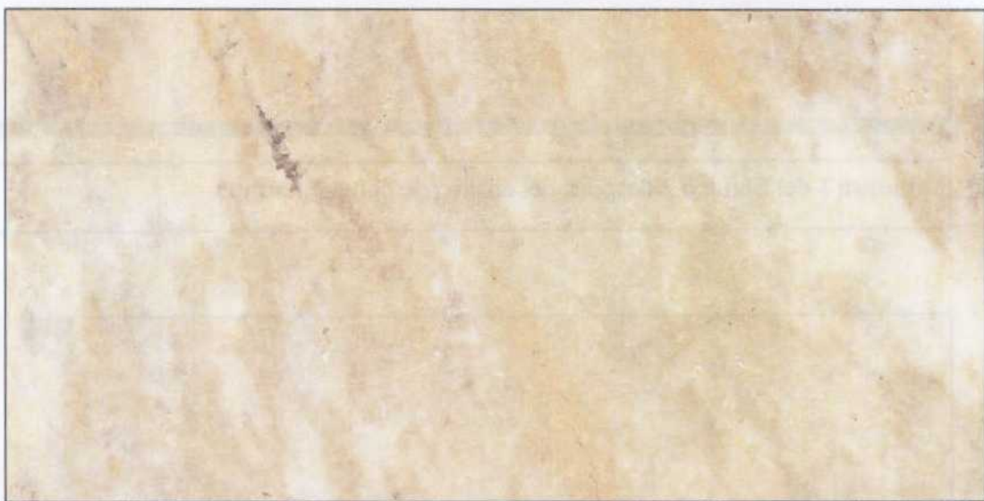
Muestra 3 del Sondeo 3 después del ensayo de choque térmico.
