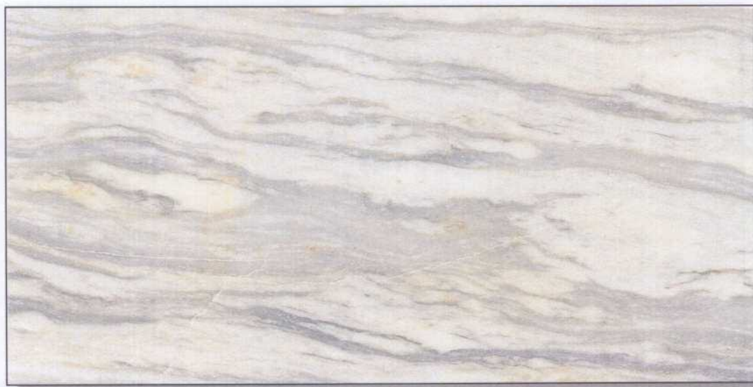
Muestra E2CL después del ensayo de choque térmico.
