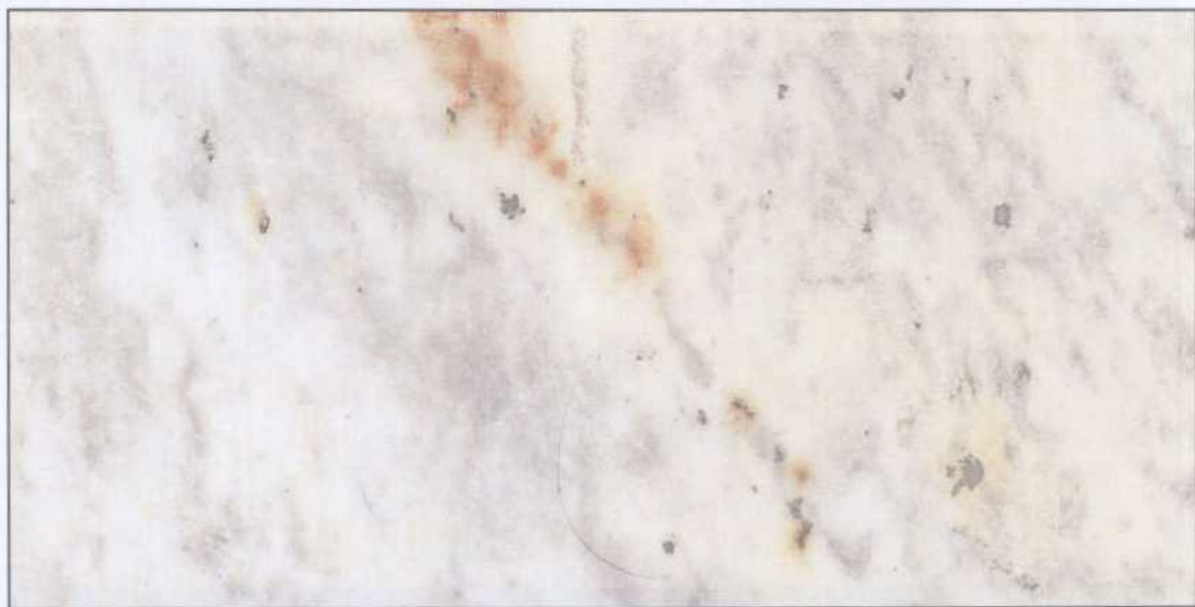
Muestra 2 del Sondeo 3 después del ensayo de choque térmico.
