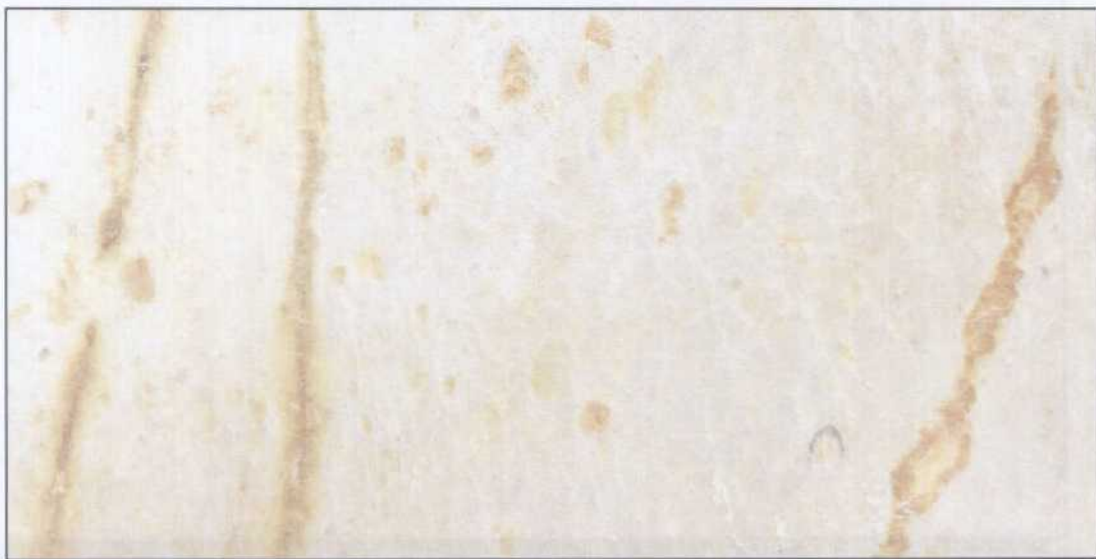
Muestra E70CL después del ensayo de choque térmico.
