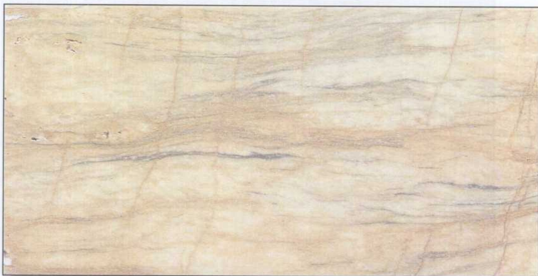
Muestra E7L antes del ensayo de choque térmico.
