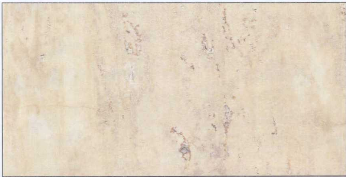
Muestra E12L después del ensayo de choque térmico.
