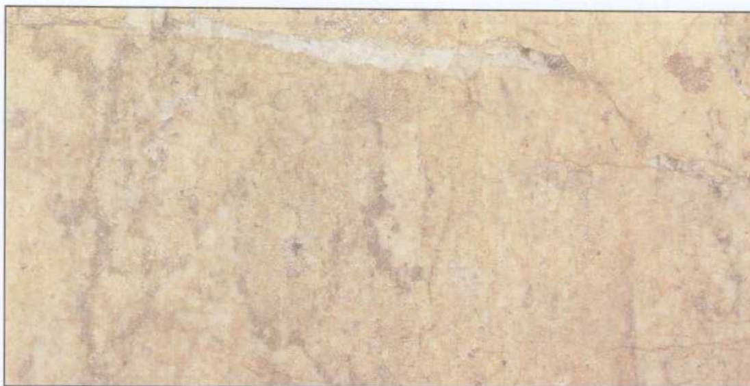
Muestra 1 del Sondeo 3 antes del ensayo de choque térmico.
