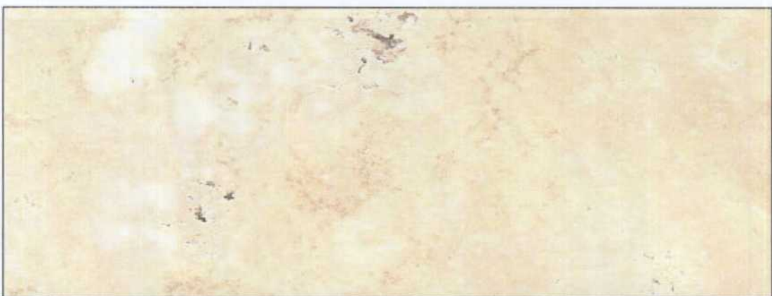
Muestra 2 del Sondeo 2 después del ensayo de heladicidad.
