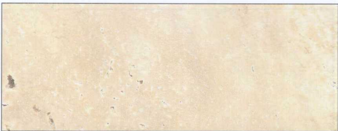
Muestra 2 del Sondeo 2 después del ensayo de choque térmico.
