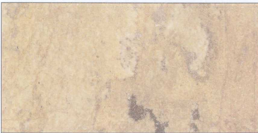
Muestra 1 del Sondeo 3 después del ensayo de choque térmico.
