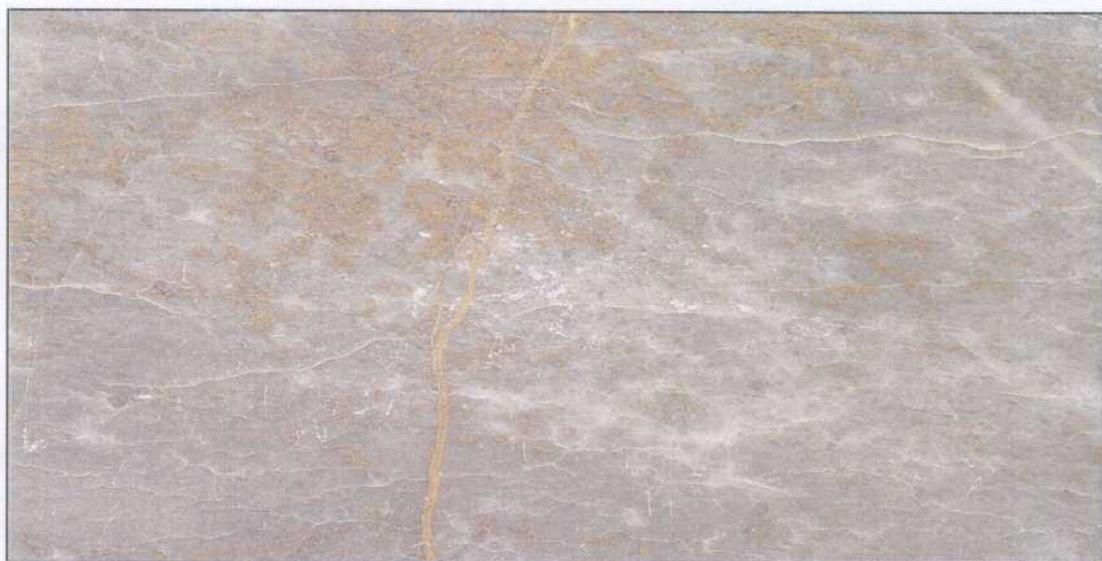
Muestra E77L después del ensayo de choque térmico.
