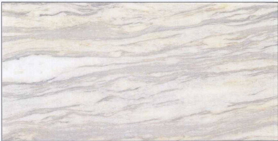
Muestra E2CL antes del ensayo de choque térmico.
